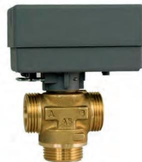
Nach dem Anschließen des Antriebs gemäß dem Schaltplan auf der Zeichnung wird das Ventil in der Ausgangsposition bleiben, d.h. der Durchfluss erfolgt von Anschluss AB nach B, wenn die Spannung nur auf den braunen Draht angelegt wird. Wenn jedoch Spannung auf den braunen und den schwarzen Draht angelegt wird, wird das Ventil in die Position AB-A umgeschaltet. Nach dem Entfernen der Spannung vom schwarzen Draht wird das Ventil wieder in die Position AB-B zurückkehren.
